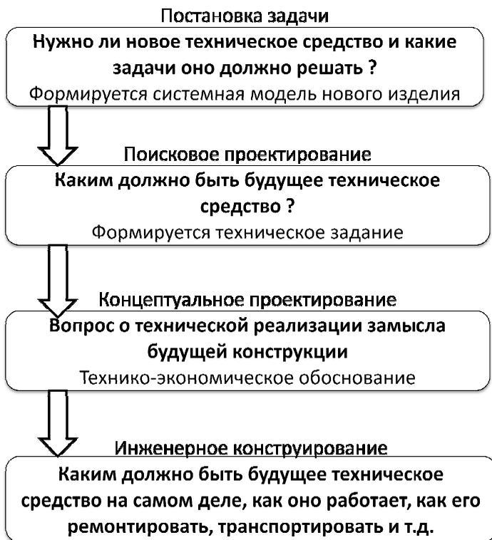
Рис. 13.1. Схема проектирования
